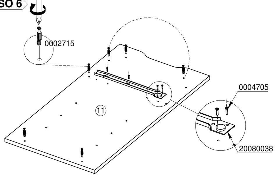
SI EL MUEBLE VA SER ARMADO EN IZQUIERDO, LOS PERNOS SE INSTALAN AL OTRO EXTREMO Y SE DEBE INSTALAR LA CORREDERA QUE SE INSTALO EN LA PIEZA # 07
