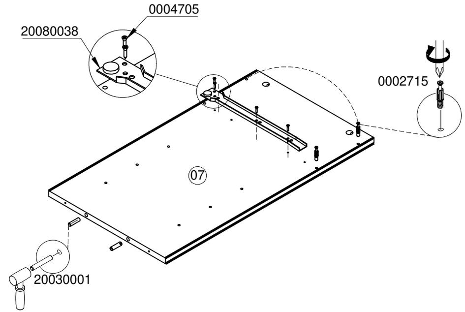
SI EL MUEBLE VA SER ARMADO EN IZQUIERDO, LOS PERNOS SE INSTALAN AL OTRO EXTREMO Y SE DEBE INSTALAR LA CORREDERA QUE SE INSTALO EN LA PIEZA # 11
