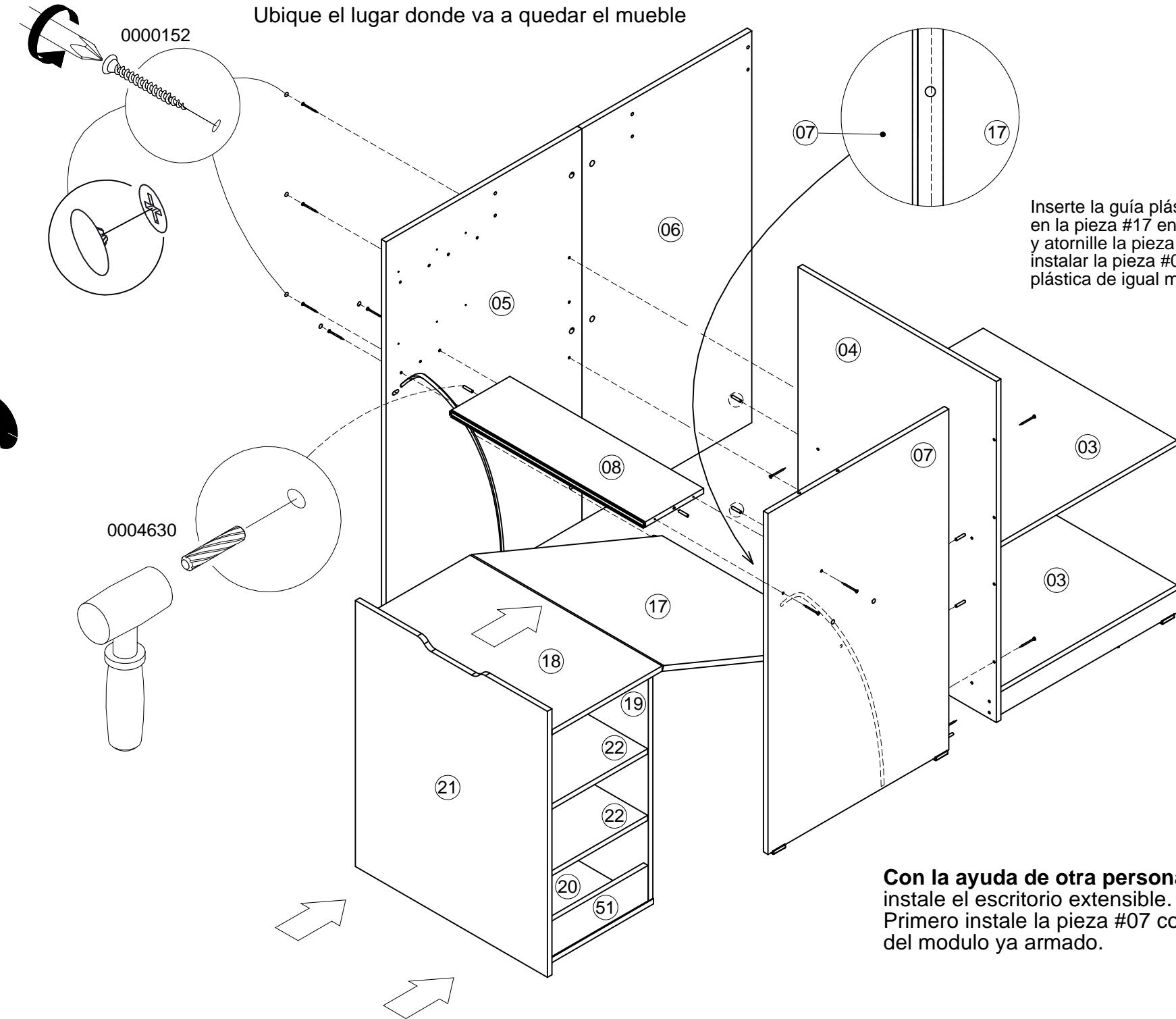
Inserte la guía plástica que ya esta instalada en la pieza #17 en la ranura de la pieza #07 y atornille la pieza #08 para posteriormente instalar la pieza #05 insertando la guía plástica de igual manera que en la pieza #07
