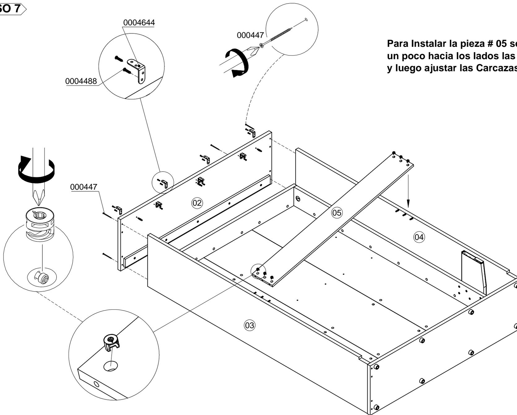
**Para Instalar la pieza # 05 se Debe abrir un poco hacia los lados las Piezas 03 y 04 y luego ajustar las Carcazas**
