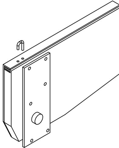
Hacer, palanca con un destornillador de pala para retirar el pin de seguridad
