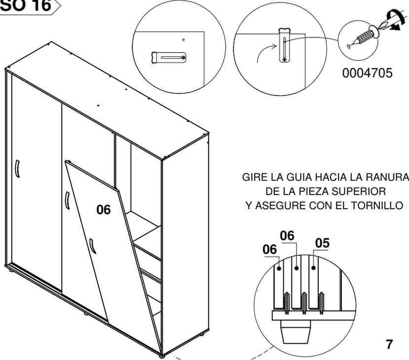
GIRE LA GUIA HACIA LA RANURA DE LA PIEZA SUPERIOR Y ASEGURE CON EL TORNILLO
