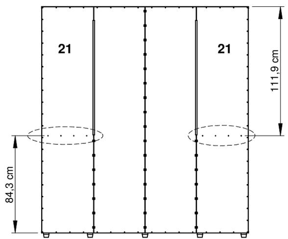
INSTALE LAS PUNTILLAS CON LA DISTANCIA REQUERIDA
