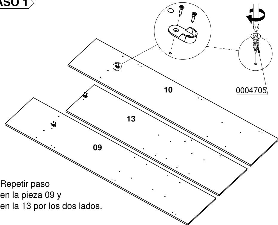
Repetir paso en la pieza 09 y en la 13 por los dos lados.
