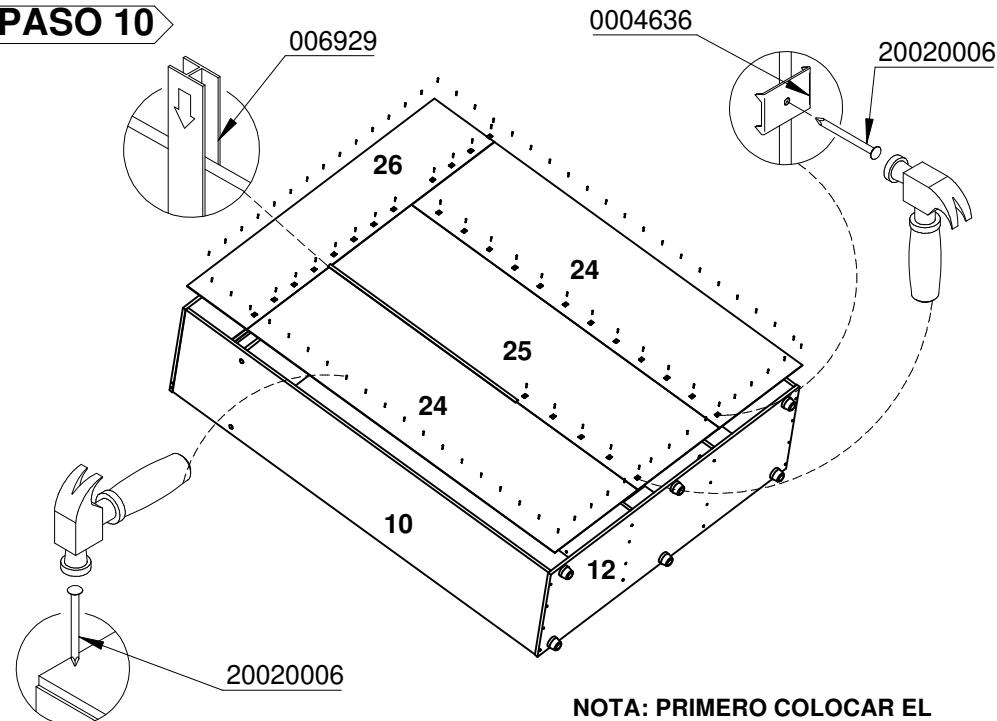
NOTA: PRIMERO COLOCAR EL EMPALME H-3 Y DESPUES COLOCAR GRAPAS Y PUNTILLAS
