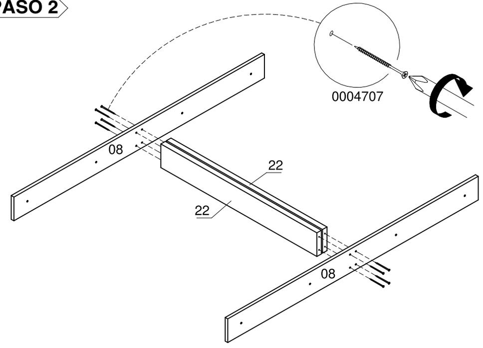
Repetir este paso para obtener dos ensambles iguales
